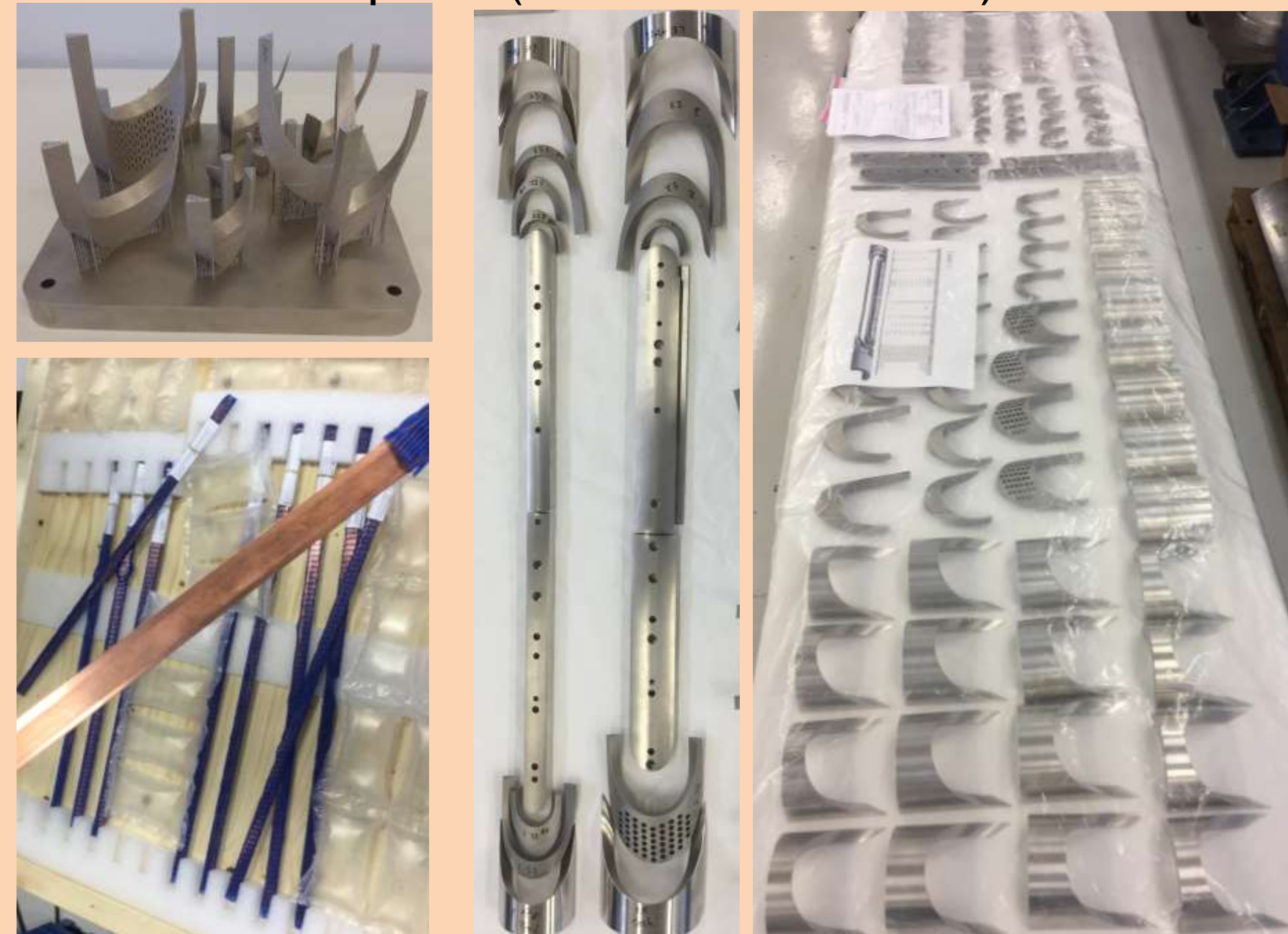
Ti and Cu wedges, Ti poles & spacers, SS saddles
